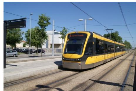
A motorização é variável dependendo da topografia das vias onde é implantado, com variação de 33% a 100% dos eixos com motores.
