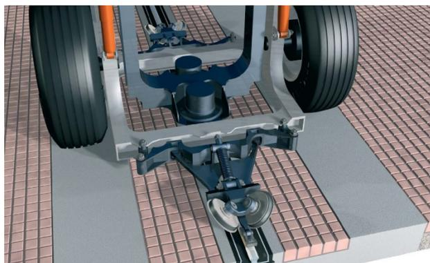
O pavimento empregado nas pistas é em concreto armado convencional, de igual forma como nos corredores de ônibus do tipo BRT, de construção tradicional, com espessura de 30 cm. A laje serve tanto à fundação, como faixa de rolamento dos pneus. Vale mencionar, que o fabricante sugere o uso de pré-fabricados de concreto, retos e curvos com comprimento de 6 metros e fixados por hastes roscada para união dos módulos.
